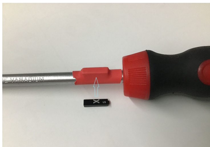
ドライバーの根元への小型タグ取り付け例
